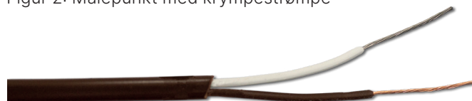
Figur 3: Kabelende ved målekanalen
