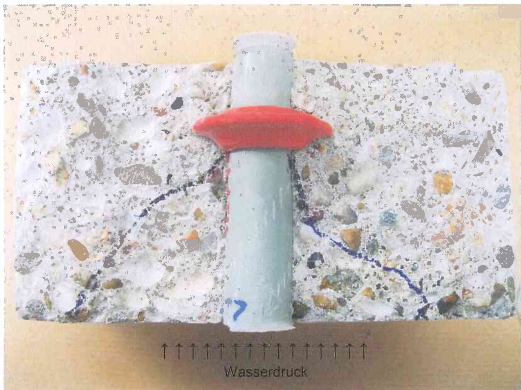
Bild A5: Probe 4: Kunststoffrohr ( \varnothing_{\text{innen}} = 22 \text{ mm} , \varnothing_{\text{außen}} = 26 \text{ mm} ); negativer Wasserdruck auf den Stopfen
