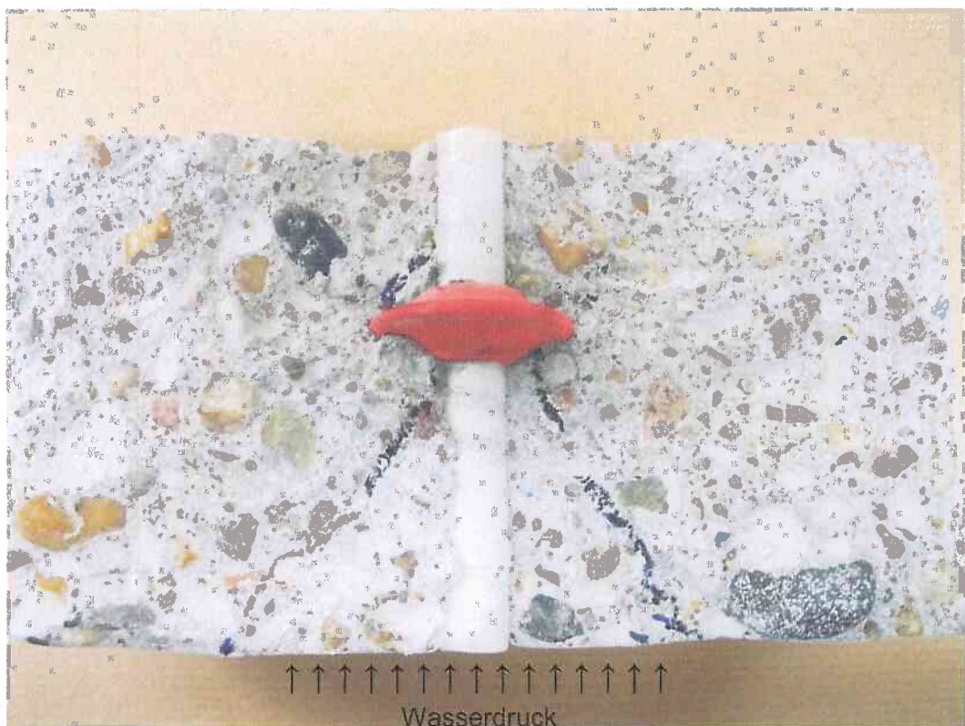
Bild A3: Probe 2: Glasfaserstab (gerippt \text{\O} = 14 \text{ mm} )
