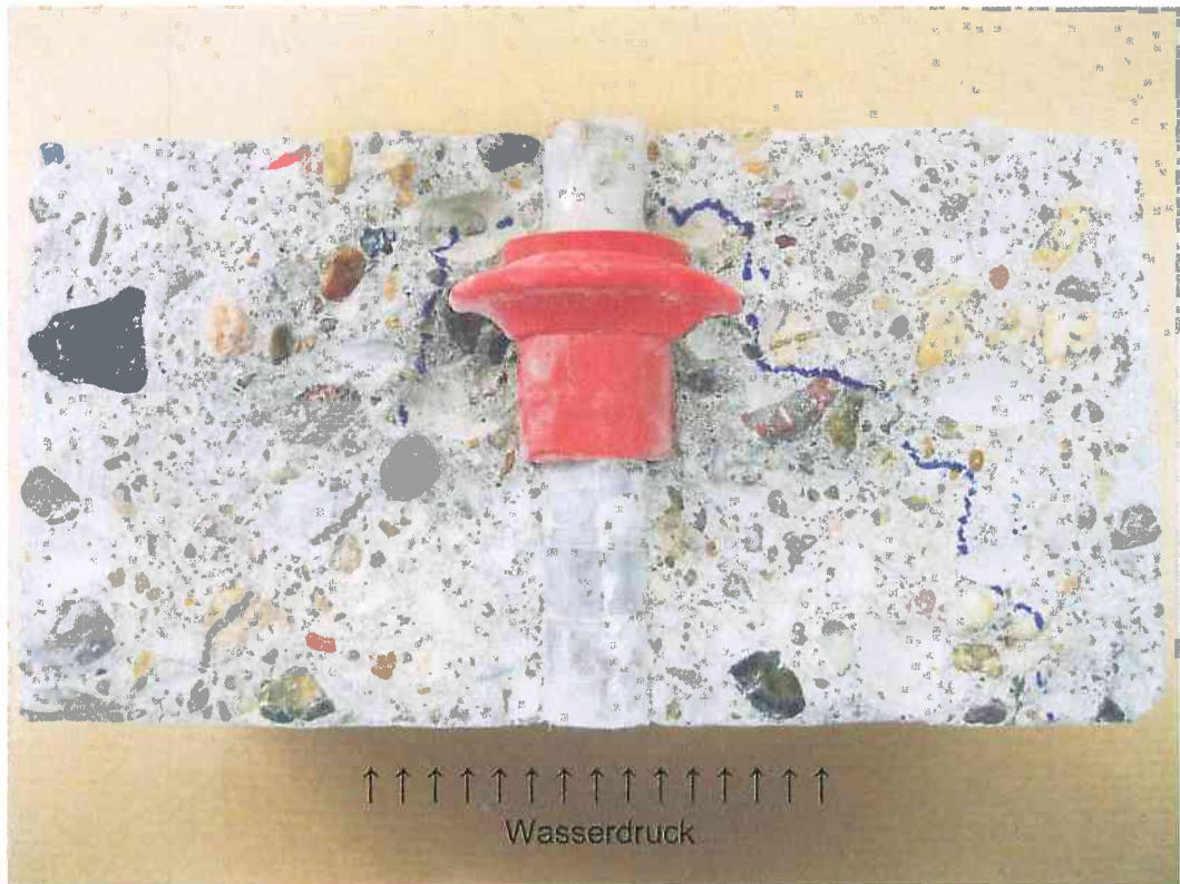
Bild A2: Probe 1: Ankerstab (Stahl gerippt \text{\O} = 16 \text{ mm} )
