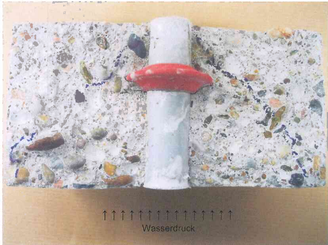
Bild A4: Probe 3: Kunststoffrohr ( \varnothing_{\text{innen}} = 22 \text{ mm} , \varnothing_{\text{außen}} = 26 \text{ mm} )
