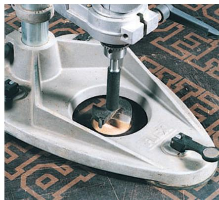
Diameteren på 60 mm gjør det mulig å reparere selv større skader.
